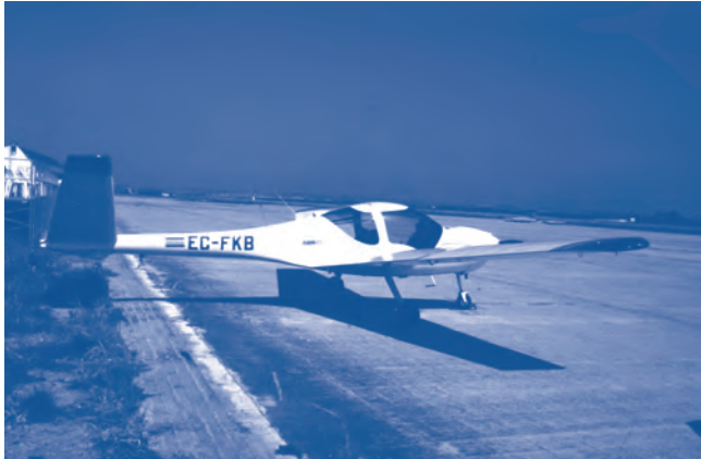
Foto 10. Un Robin ATL, típic exemple de construcció lleugera actual. Pot apreciar-se com l'ús integral de GRP i compòsits per a l'estructura ha permès adoptar formes complexes en doble curvatura que haurien requerit un treball llarg i costós si s'hagués hagut d'emprar el metall. (Foto de l'autor.)
