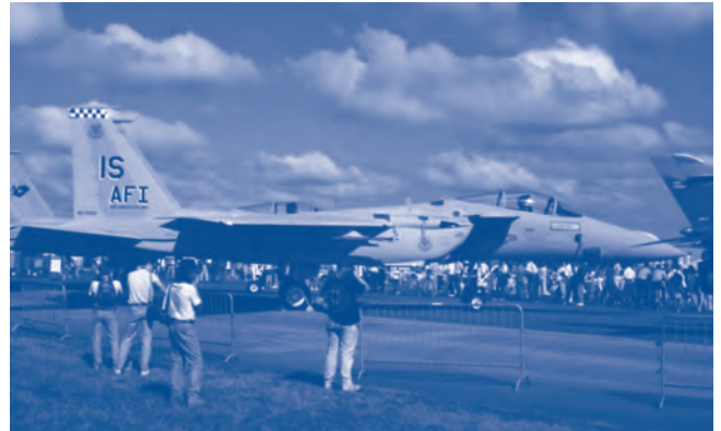
Foto 11. Els plafons laterals de les derives d'aquest F-15 són un dels pocs casos on ha estat possible emprar la fibra de bor. Pot apreciar-se com les superfícies presenten una curvatura molt suau. (Foto de l'autor.)
